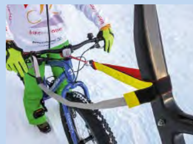
En tirant sur le ruban gris, la bande velcro s'ouvre, ce qui permet de détacher le vélo de l'arbalète.
